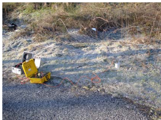
Acquisizioni dei dati sismici relativi alle prove HVSR
