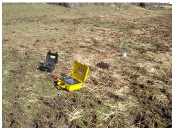
Acquisizioni dei dati sismici relativi alle prove HVSR
